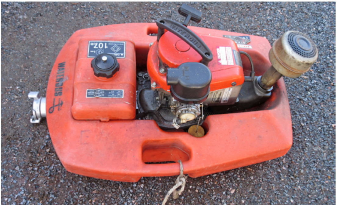
Kuva 10. Kellupumppu on kevyt ja tarvitsee toimiakseen vain noin 10 cm syvyisen vedenottoaikan (Kuva: Jussi Laurila).
