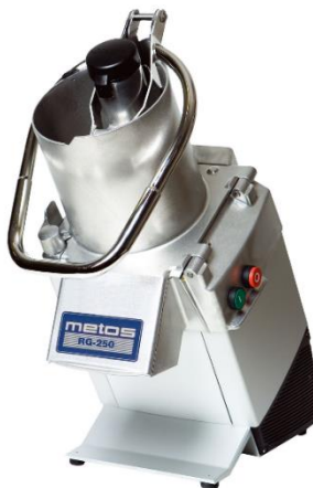
Kuva 40. Kutterilla voidaan hienontaa raaka-aine rouheeksi ja jauhoksi.
