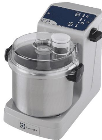
Kuva 41. Vihannesleikkurilla saadaan erilaisia partikkelikokoja tehtyä kovasta raaka-aineesta esimerkiksi voikukan juuresta. Kuva www.metos.fi
