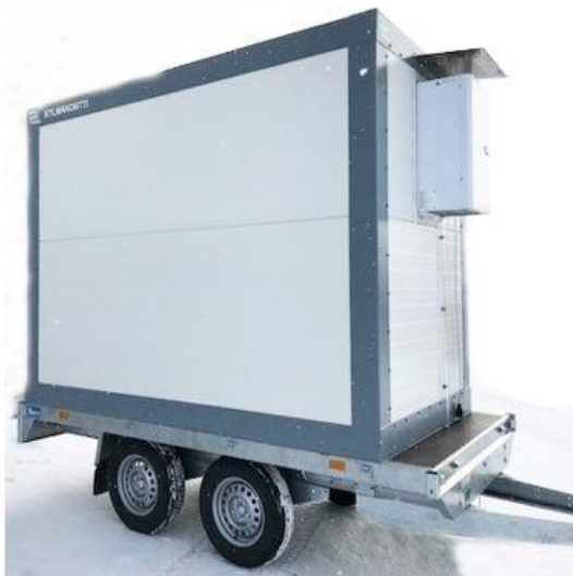
Kuva 32. Pakastekärry toimii omana kuljetusyksikkönä ja sitä voi kuljettaa B-ajokortilla. Pakastekontit kuljetetaan rekka-autoilla. Pakaste- ja kylmäkontteihin mahtuu raaka-aineita 6–70 m 3
