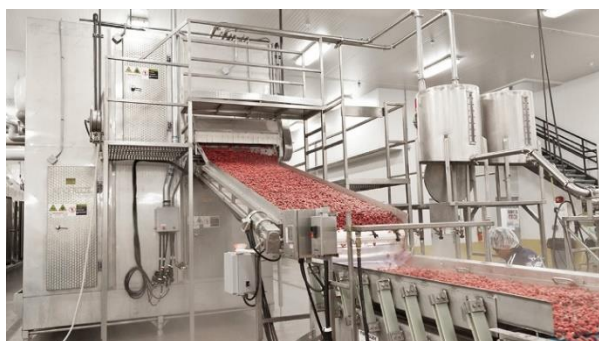
Kuva 39. Puhdistus toteutuu teollismitta-kaavaisessa tunnelipakastuksessa vasta jäätyneestä raaka-aineesta.
