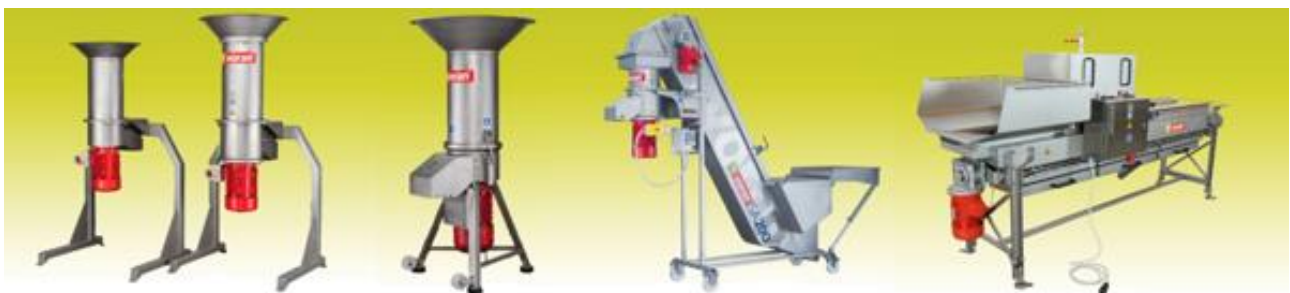
Kuva 42. kasvinosien murskaukseen on saatavilla teknologisia välineitä. Kuvassa erilaisia murskaimia. Kuva: www.mehupuristin.fi
