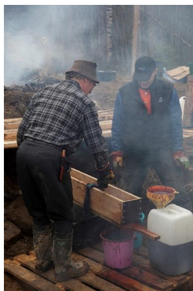
Kuva 66. Pienenkin tervahaudan poltto kestää 2 vrk kunnes tervaa alkaa valumaan tervahaudan alaosaan sijoitetusta valumiskaukalosta.
